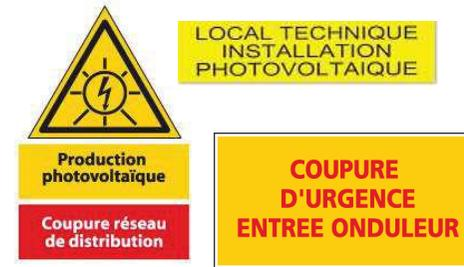
Figure 186 : Exemples de signalisation sur une installation photovoltaïque
