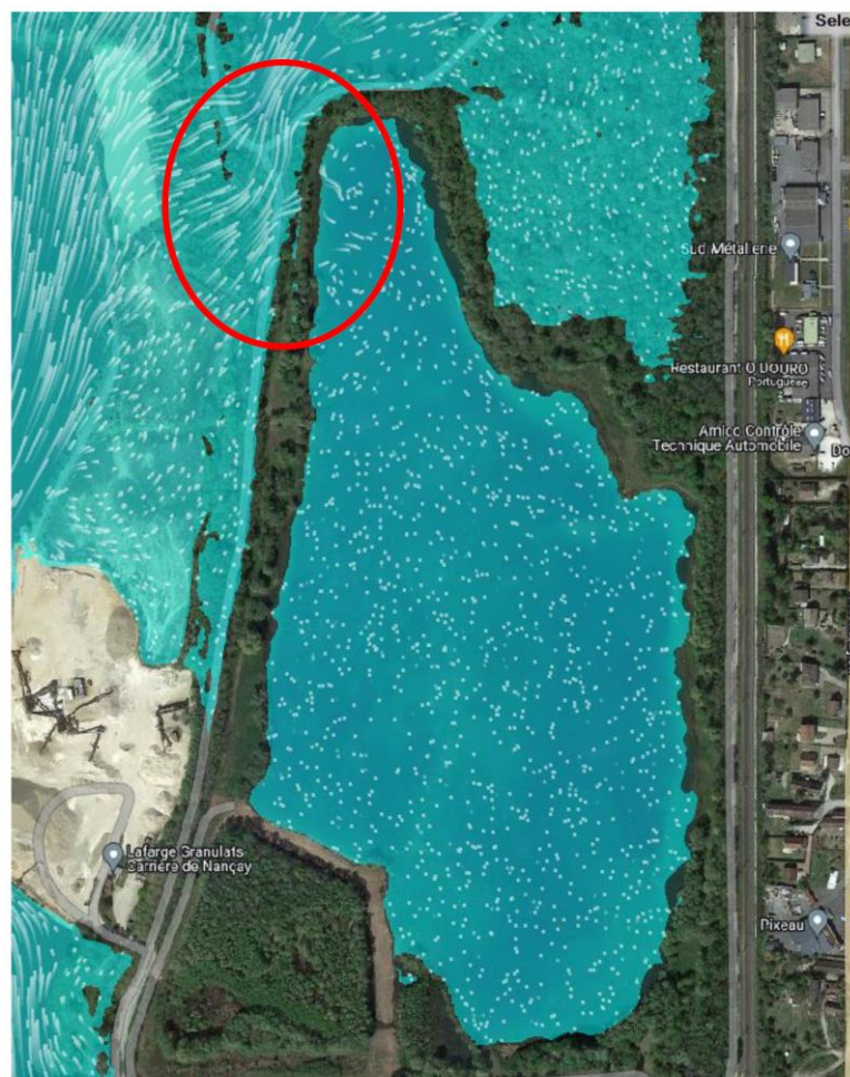
Figure 30 : Premières entrées d'eau dans la gravière (source : ISL Ingénierie, janvier 2023)
